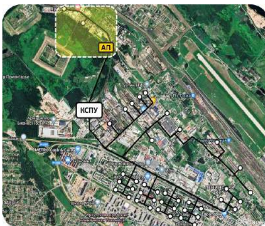
Рис. 1. Исследуемая ТСС на карте местности (приблизительная конфигурация): КСПУ – котельная, АП – активный потребитель (просьюмер)
