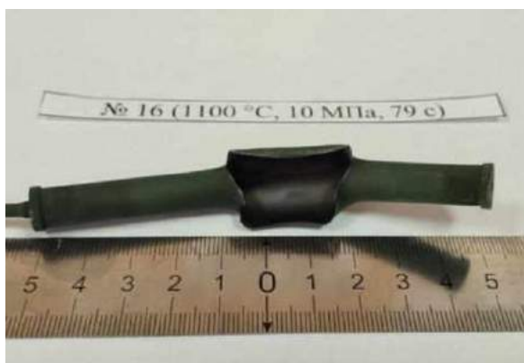
Рис. 3. Внешний вид Э110+Cr ампулы, испытанной в паре при 1100 °С, 10 МПа
